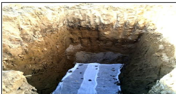
3.3.2 Сурет – Зерттеудің эксперименталды телімінде инфильтрациялық алаптың физикалық мини моделінің – шурф негізінде тесікті тор мен дәкелі тұтастырғышты орналастыру
