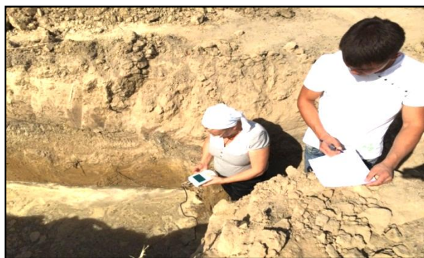
3.3.3 Сурет – Зерттеудің эксперименталды телімінде инфильтрациялық алаптың физикалық мини моделінде лайды өлшегішпен судың лайлылығын өлшеуді орындау
