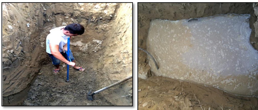
3.2.1 Сурет – Грунт сулары деңгейіне дейін топырақты бұрғымен бұрғылау және Қаратал өзенінен сумен мини инфильтрациялық алаптың толуы
