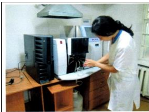
3.3.4 Сурет – Спектрлік фотометрде дайындалған суспензияның оптикалық тығыздығын өлшеу
