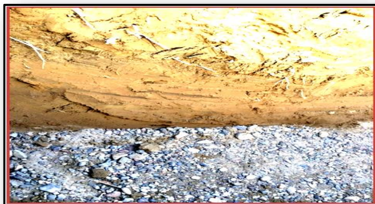
3.3.1 Сурет - Зерттеудің эксперименталды телімінде инфильтрациялық алаптың физикалық мини моделінің – шурф түбінде гравийлі материалдың қабаты
